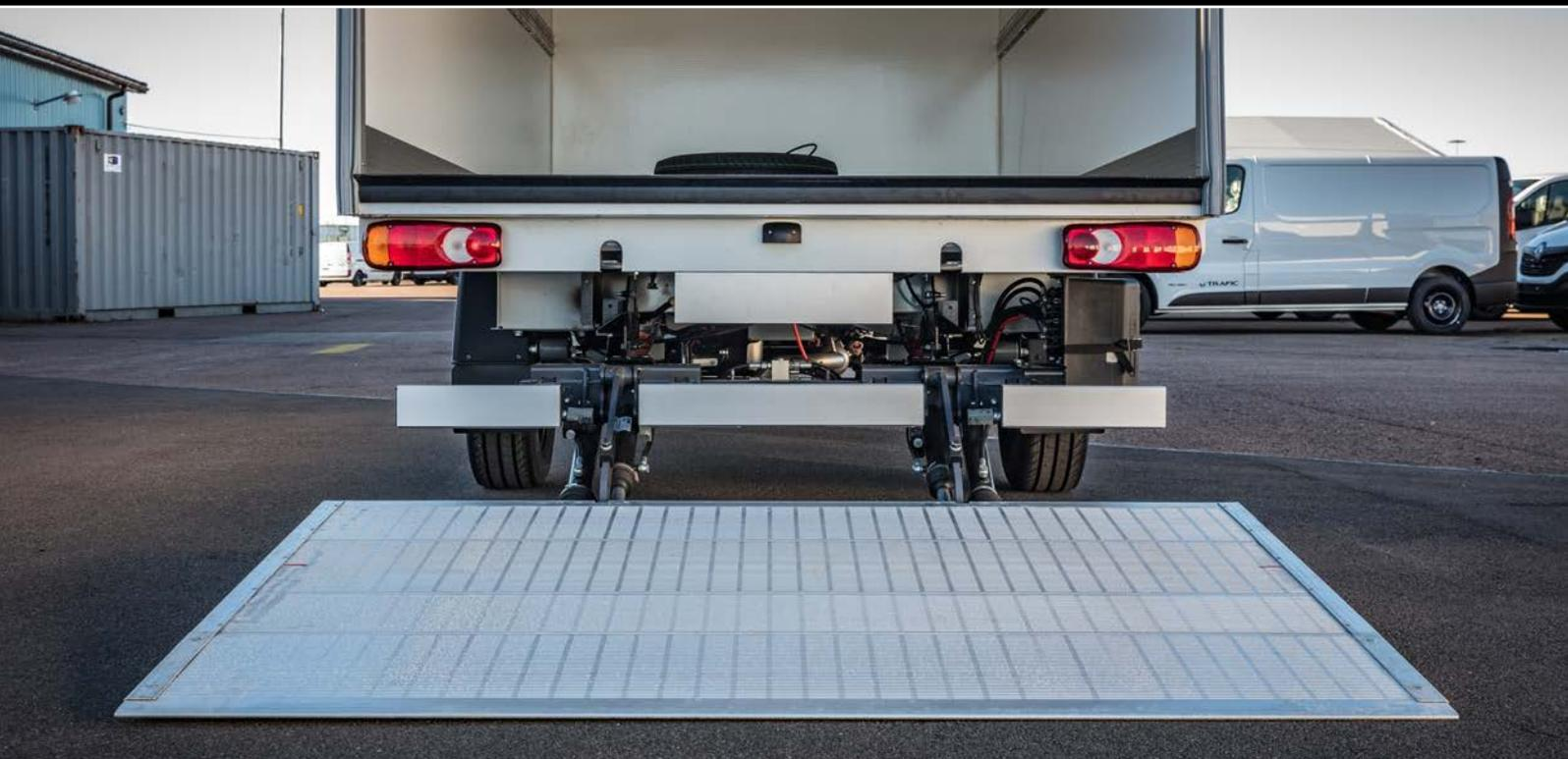
*Ihr flexibles und robustes Design macht sie zur besten Wahl für alle leichten Fahrzeuge, deren Betriebszeit maximiert werden soll. Mit pulverlackiertem Stahlrahmen und Aluminium-Plattform in verschiedenen Größen und Optionen.*
